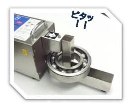
1. 温度センサをセンサコンセントに接続し、検出端をベアリング内輪の上に設置します。
